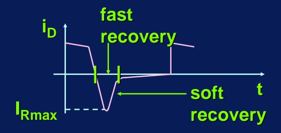
I diodi vanno scelti soft-recovery (per ridurre la sovratensione) e fast-recovery (per ridurre l<sub>Rmax</sub> e le perdite)
