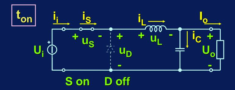
$$\begin{split} &i_i = i_S = i_L = I_o + i_c \\ &u_D = U_i \quad \text{(diodo contropolarizzato)} \\ &u_L = U_i - U_o \\ &i_L(t) = i_L(0) + \frac{1}{L} \cdot \int_0^t u_L(\tau) d\tau = i_{L min} + \frac{U_i - U_o}{L} \cdot t \end{split}$$
