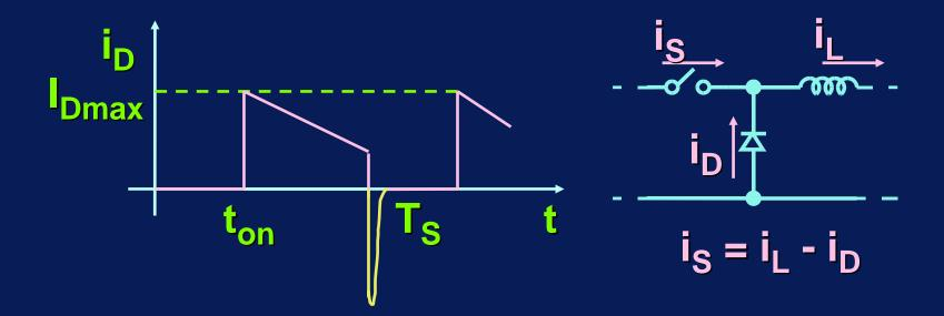
Il recovery inverso del diodo causa sovracorrenti nell'interruttore
