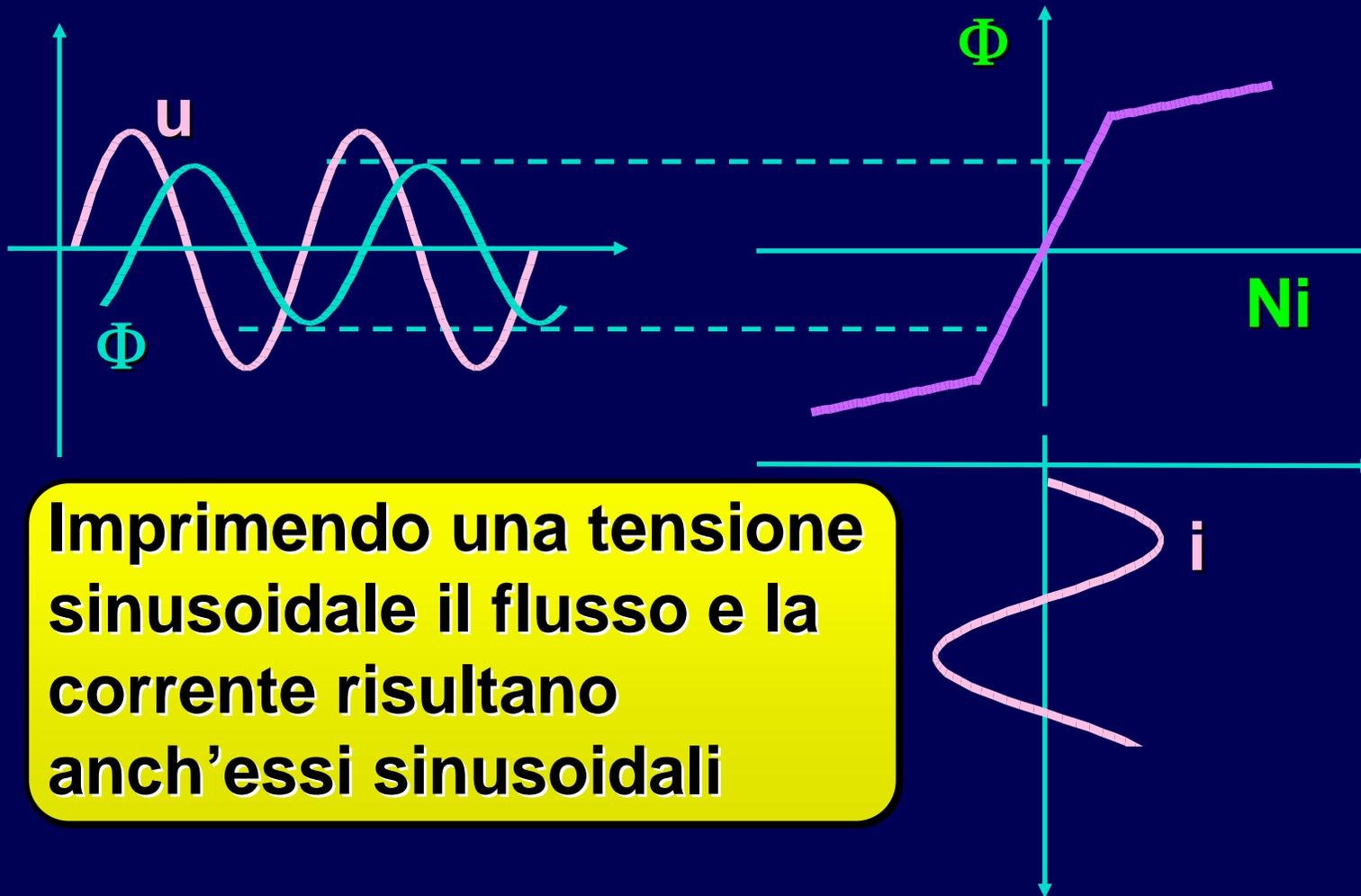
**Imprimendo una tensione sinusoidale il flusso e la corrente risultano anch'essi sinusoidali**
