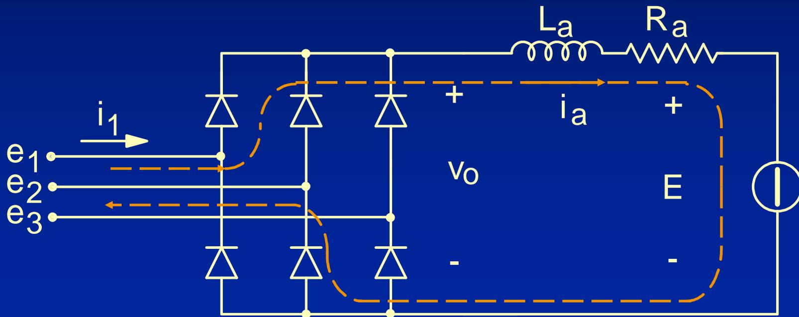
Il passaggio della conduzione da un diodo all'altro (commutazione) avviene naturalmente all'incrocio tra le forme d'onda delle tensioni di due fasi successive
