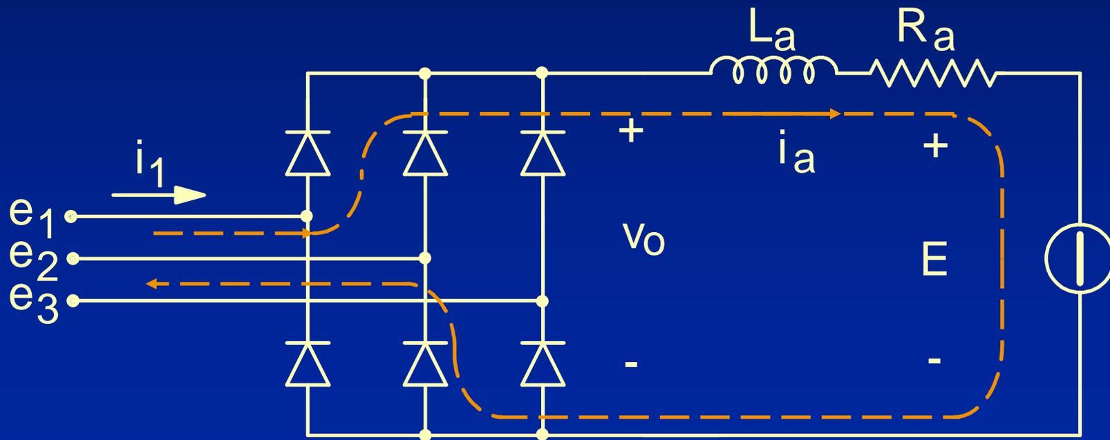
Vi sono sempre solo due diodi in conduzione contemporanea, uno nella parte superiore ed uno nella parte inferiore del ponte
