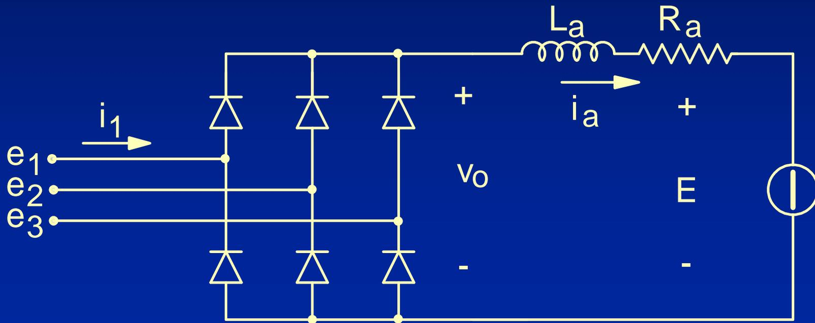
Nella parte superiore del ponte, conduce il diodo connesso alla fase la cui tensione istantanea è massima e, nella parte inferiore, il diodo connesso alla fase la cui tensione istantanea è minima
