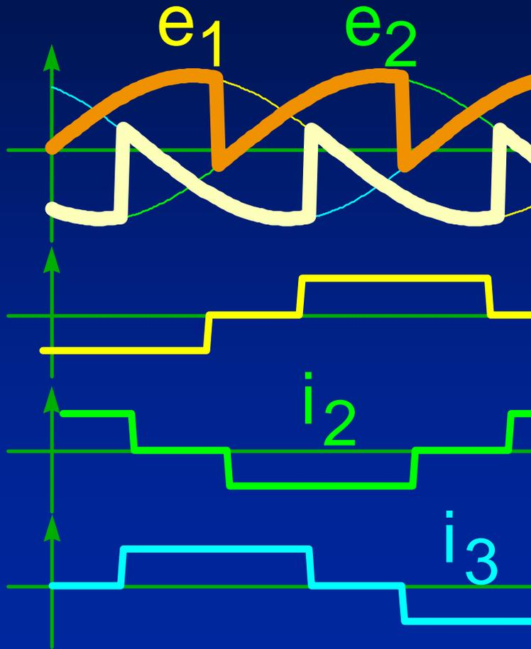
Per  $\alpha > 90^\circ$  la tensione di uscita si inverte mentre la corrente rimane positiva. Si inverte così il verso della potenza in c.c. e si richiede, nel circuito in continua, la presenza di un generatore che eroghi tale potenza verso il lato c.a.
