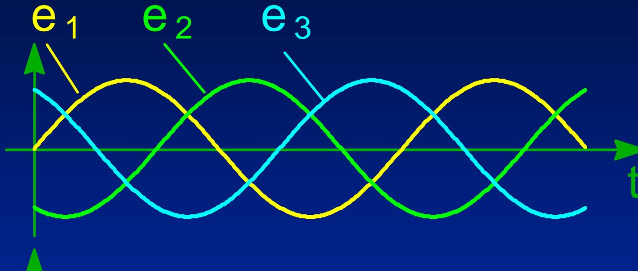
Nel circuito in continua, l'uscita positiva segue la tensione della fase con valore istantaneo massimo
