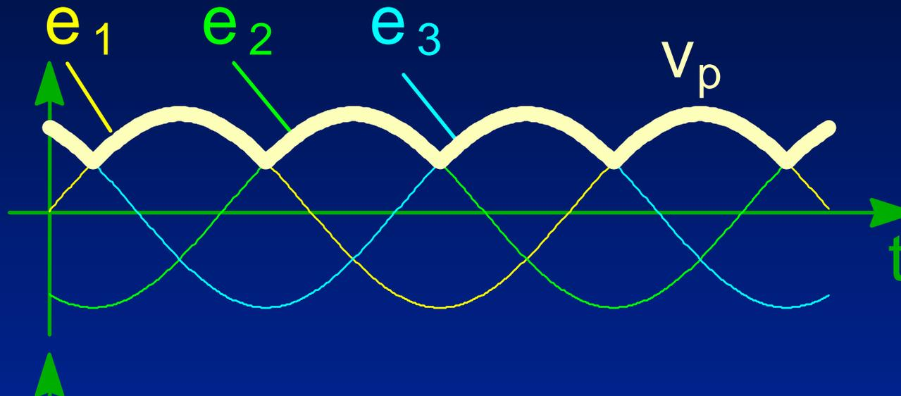
Nel circuito in continua, l'uscita positiva segue la tensione della fase con valore istantaneo massimo
