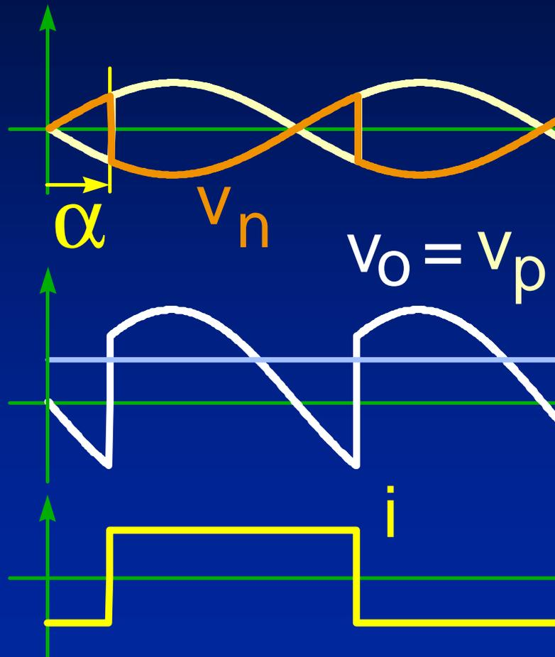
In un ponte monofase controllato, la corrente di fase è ritardata di un angolo  $\alpha$  analogamente a quanto si verifica nei ponti trifase
