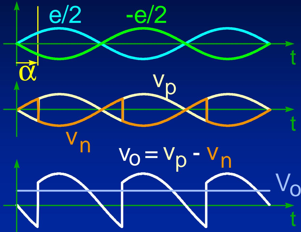
Nel ponte monofase controllato la tensione media di uscita è anch'essa proporzionale a  $\cos(\alpha)$ :
