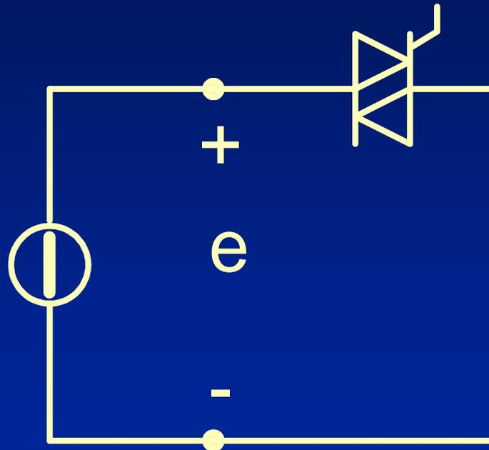
Come è noto, il triac è un componente che si comporta come una coppia di SCR connessi in parallelo in verso opposto, con un unico elettrodo di comando
