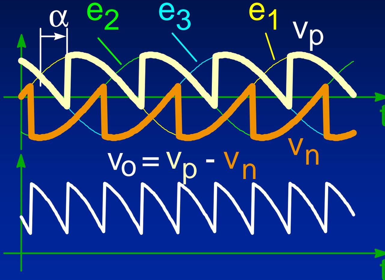
Il valore medio della tensione di uscita diminuisce all'aumentare dell'angolo  $\alpha$ . Tale valore medio diventa negativo per valori di  $\alpha$  maggiori di 90 gradi (funzionamento da invertitore)
