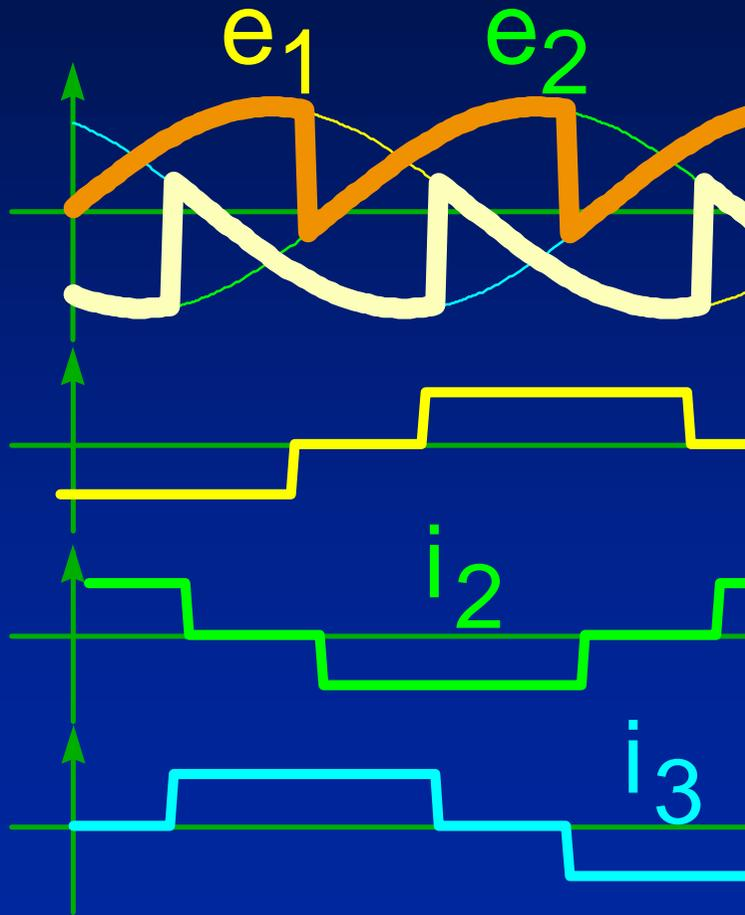
La potenza nelle fasi diventa anch'essa negativa perché la componente fondamentale della corrente di fase risulta sfasata più di  $90^\circ$  rispetto alla corrispondente tensione
