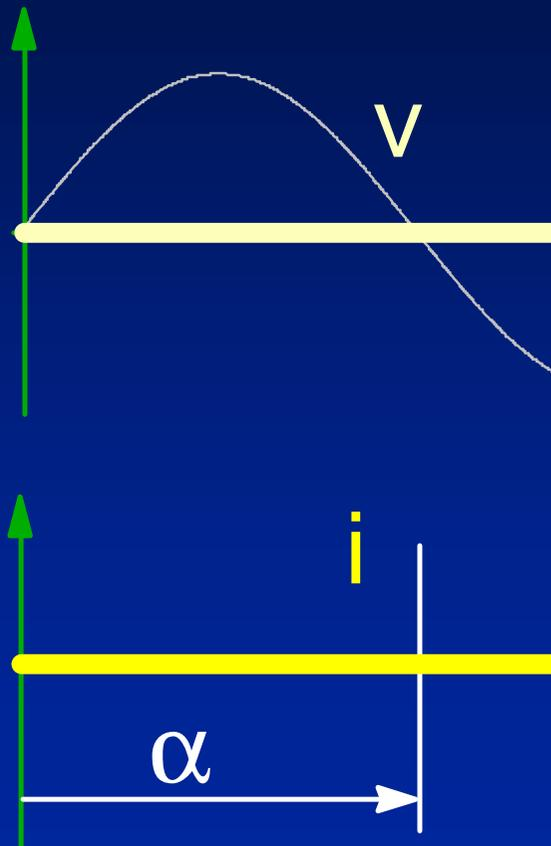
La regolazione deforma la tensione e la corrente sul carico introducendo uno sfasamento ed una grande quantità di armoniche. Queste ultime possono essere parzialmente filtrate dal carico se esso è induttivo
