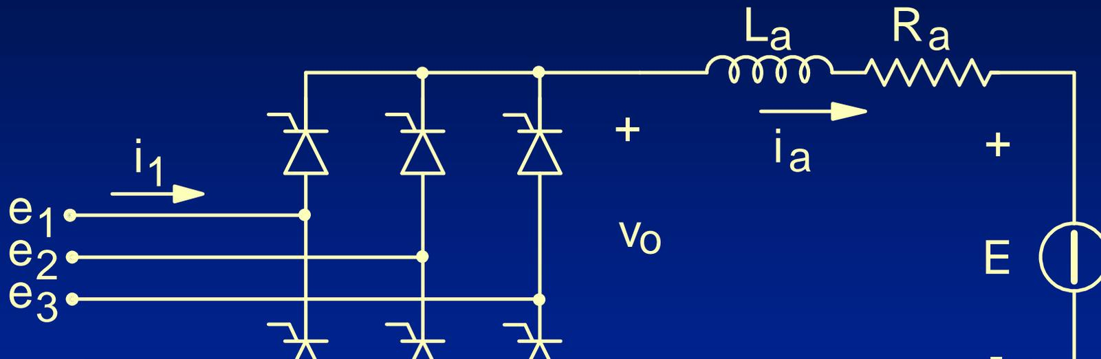
Sostituendo, sia nei ponti monofase che in quelli trifase, tutti i diodi con tiristori si ottengono ponti **totalmente controllati**
