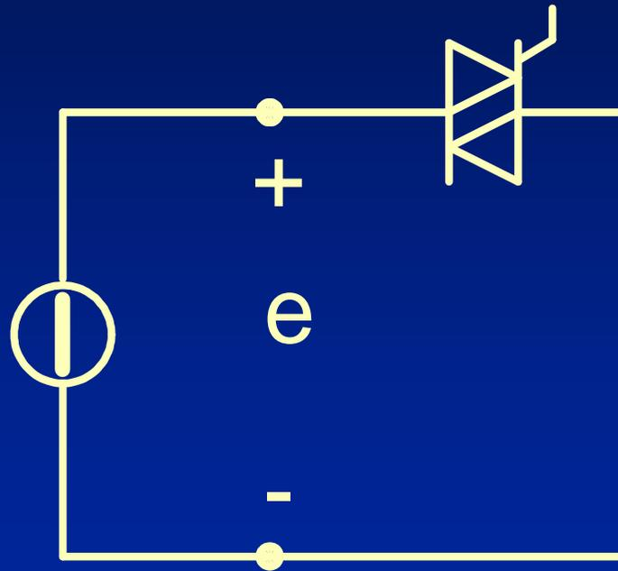
La regolazione è ottenuta ritardando l'accensione di un angolo  $\alpha$  rispetto all'inizio del semiperiodo. Si ottiene una semionda tagliata la cui componente fondamentale è inferiore a quella dell'onda piena
