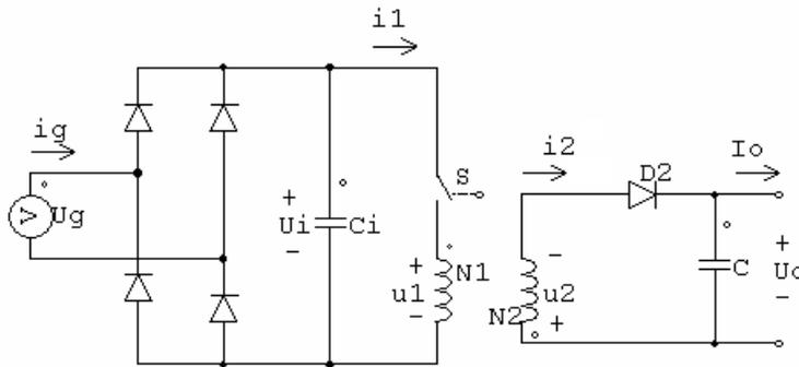
Tensione d'ingresso:  $U_g = \sqrt{2} \cdot U_{grms} \cdot \sin(2 \cdot \pi \cdot f_g \cdot t)$  con  $U_{grms} = 220V \pm 10\%$  e  $f_g = 50$  Hz
