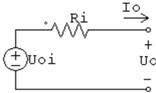
$R_i$  rappresenta la resistenza equivalente che rende conto delle perdite del sistema ( $P_{diss}$ ).
