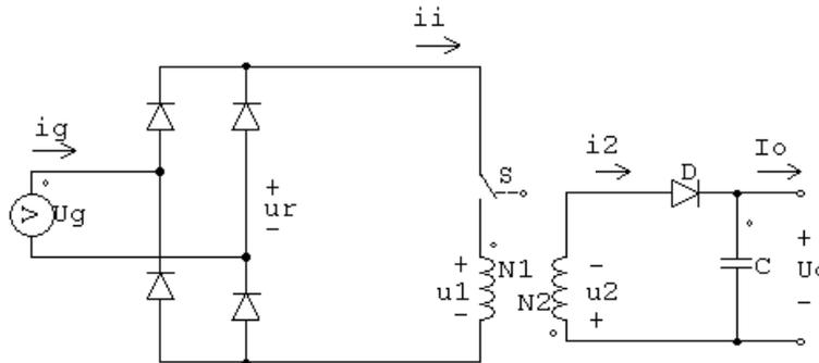
Tensione d'ingresso:  $u_g(t) = \sqrt{2} \cdot U_g \cdot \sin(\omega t)$
