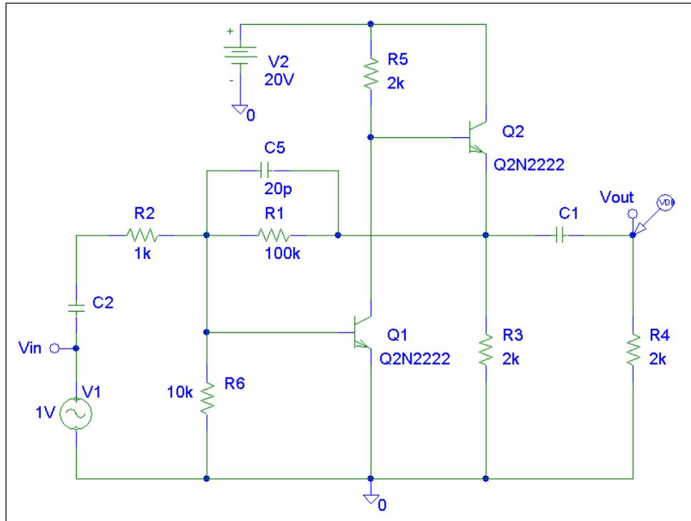
Lo schema di figura mostra uno stadio amplificatore a BJT. Utilizzando il metodo delle costanti di tempo per la bassa frequenza, determinare i valori delle capacità  $C1$  e  $C2$  per ottenere una frequenza di taglio inferiore pari a 100Hz
