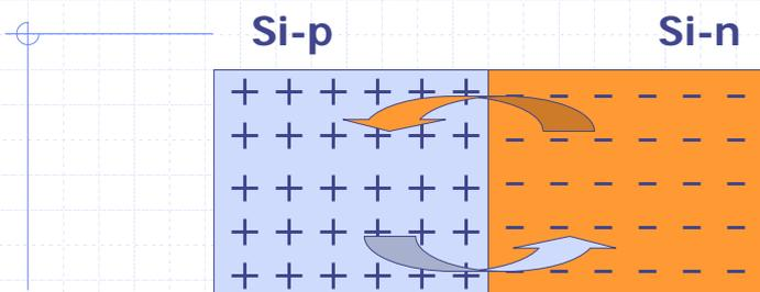
Se mettiamo a contatto Silicio drogato di tipo p con Silicio drogato tipo n, a causa degli elevati gradienti di concentrazione avremo **diffusione**:
