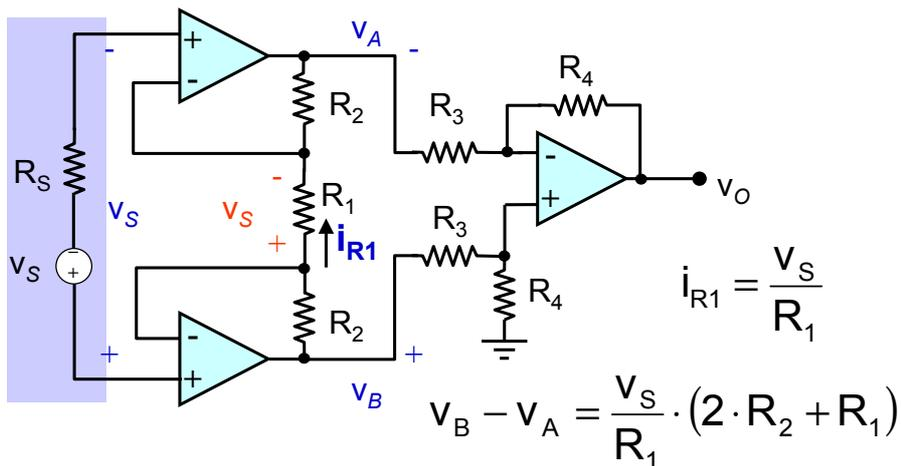
$$v_o = v_s \left( 1 + \frac{2 \cdot R_2}{R_1} \right) \frac{R_4}{R_3}$$
