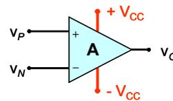
Consideriamo ora una  $A \gg 1$  (esempio  $a = 10^4$ ) e sia  $V_{cc} = 10\text{ V}$
