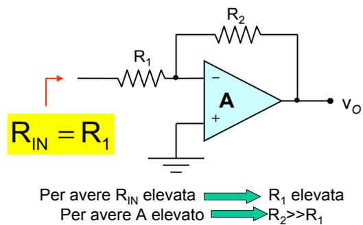
Configurazione Invertente Soffre di una bassa  $R_{IN}$
