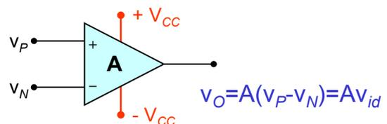
Tutte le tensioni sono misurate rispetto a massa, ma solo la differenza delle tensioni in ingresso determina l'uscita.
