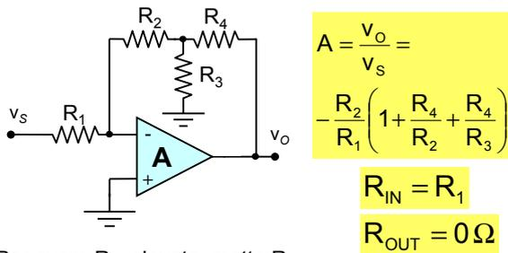
Per avere  $R_{IN}$  elevata metto  $R_1$  elevata. Con una opportuna scelta di  $R_2$ ,  $R_3$  e  $R_4$  si ottiene un guadagno  $|A|$  molto elevato.
